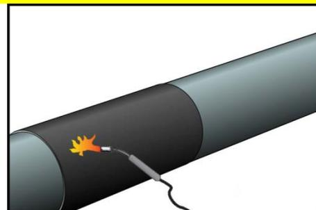
Die gesamte isojoint III® - Muffe - von einer zur anderen Seite – bis zum ordnungsgemäßen, konturgerechten und an den Enden spaltenfreien Anliegen auf der PE-X-Schrumpffolie und dem Kunststoffmantelrohr abschrumpfen.
