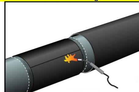
Straffes Auflegen der PE-X-Schrumpffolie mittig über die PUR-Nachdämmung. Die PE-X-Schrumpffolie mit einer weichen Propangasflamme abschrumpfen.
