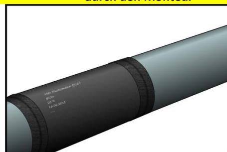
Der Monteur muss folgende Kennzeichen mit einem im Erdreich dauerhaft haltbaren Markierungsstift anbringen:
