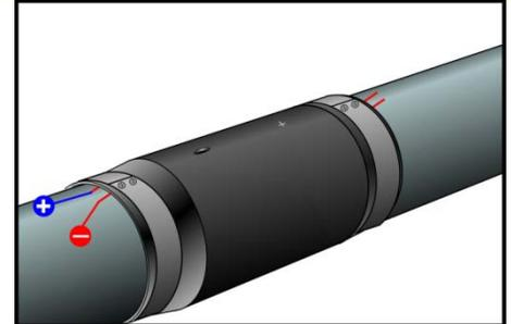
Beide Schweißzangen an den losen Enden eines Kupfer-Heizleiters anschließen, die Polung ist dabei zu vernachlässigen. Die Zangen mit einem Spanngurt oder Klebeband fixieren.
